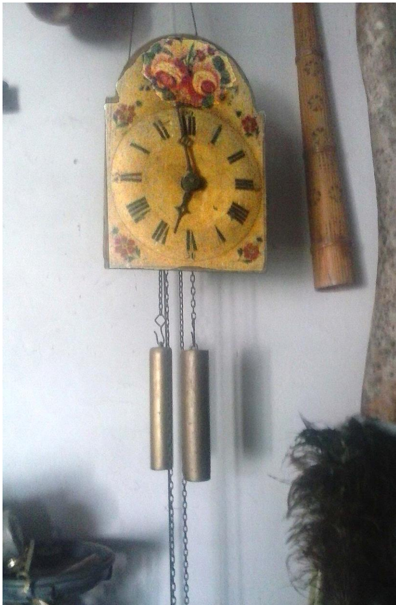
Asi dnes nejstarší pendlovky s napůl dřevěnými kolečky a vteřinovým kyvadlem (od Valtrů)
