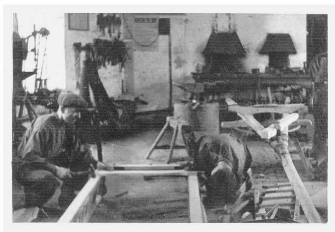
Nový vůz od koláře se kompletoval až v kovárně
