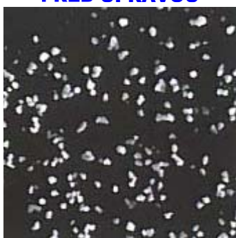
V neupravené vodě jsou viditelné krystaly \text{CaCO}_3 , které jsou v praxi pevně přilepené na stěně potrubí, bateriích, kotlů apod.
