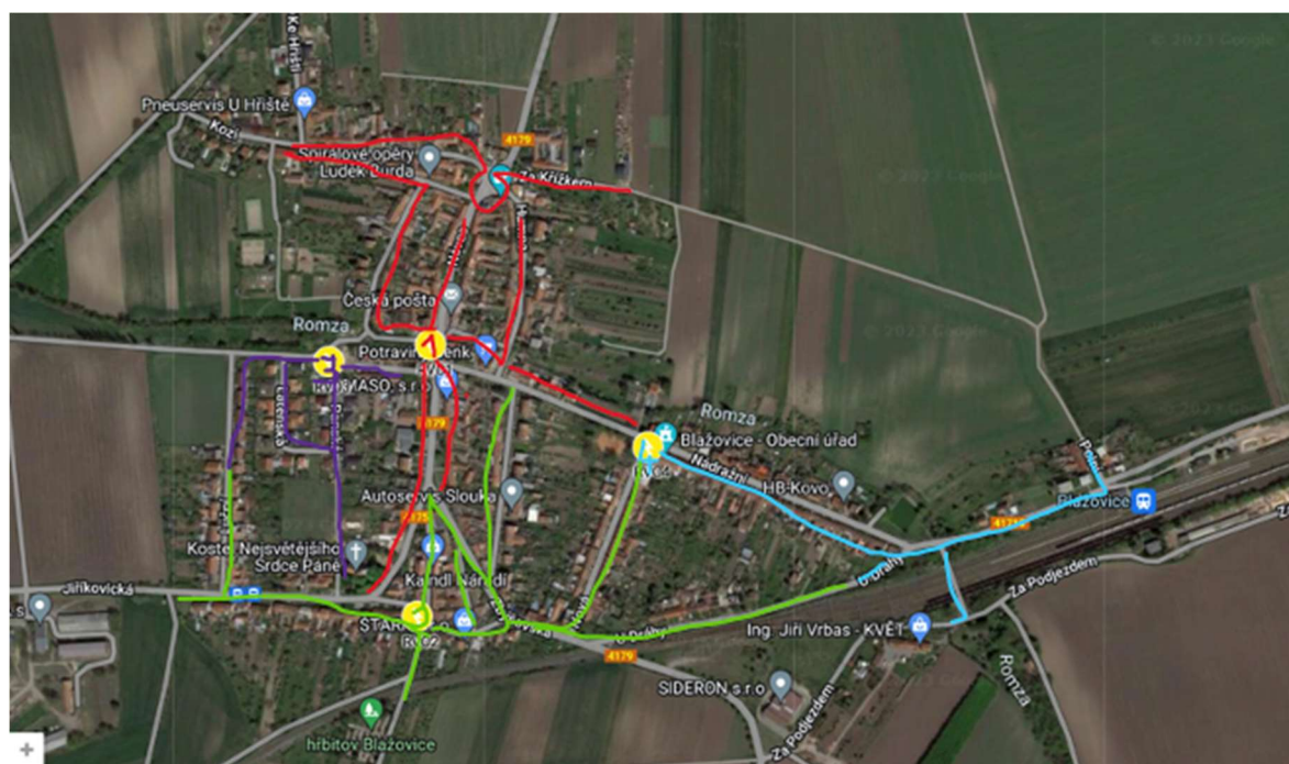
Obrázek 23 Rozdělení úseků dle rozvaděčů veřejného osvětlení 1-4
